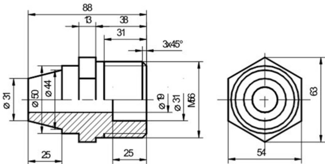
**Задача 3.** Спроектировать единичный технологический процесс обработки детали в САПР ТП ВЕРТИКАЛЬ. Тип производства – серийное. Материал детали – Сталь 40Х.
