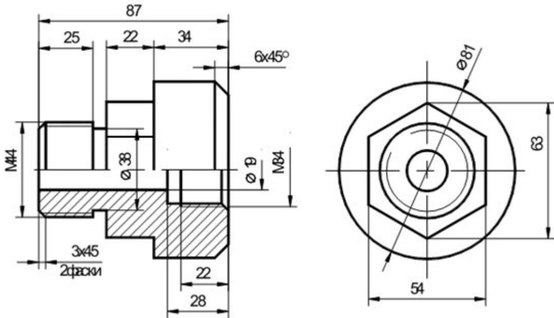
**Задача 4.** Спроектировать единичный технологический процесс обработки детали в САПР ТП ВЕРТИКАЛЬ. Тип производства – единичное. Материал детали – Сталь 40Х.
