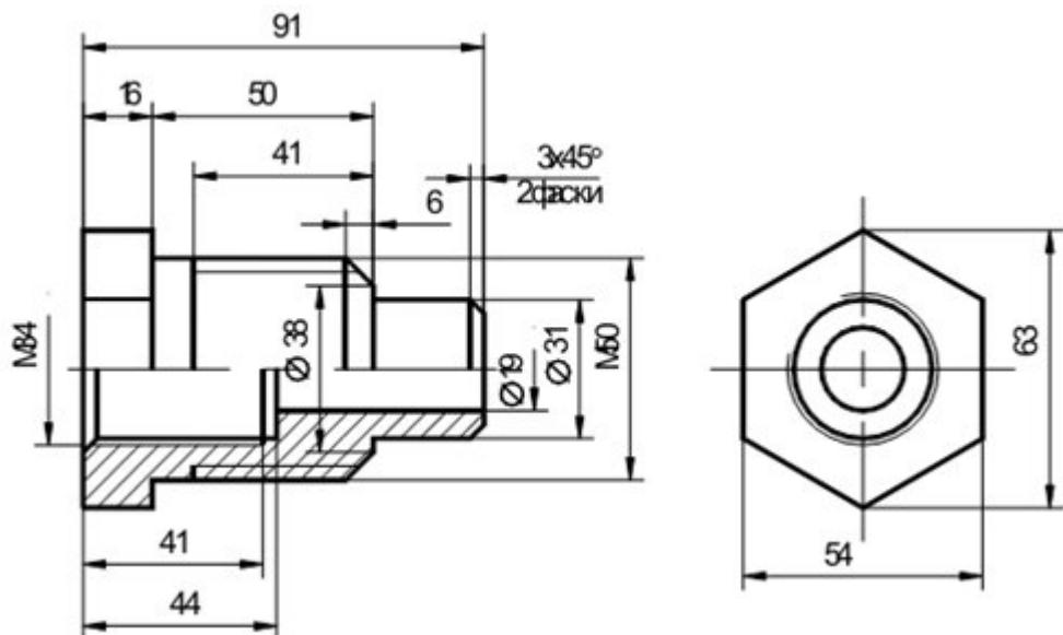
**Задача 2** Спроектировать единичный технологический процесс обработки детали в САПР ТП ВЕРТИКАЛЬ. Тип производства – серийное. Материал детали – Сталь 40Х.
